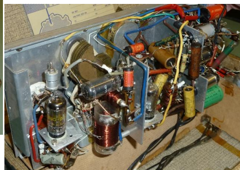
KW RX-TX (80m/40m/?) mit 6 Röhren von HB9RP, eingebaut in ein Köfferchen.
