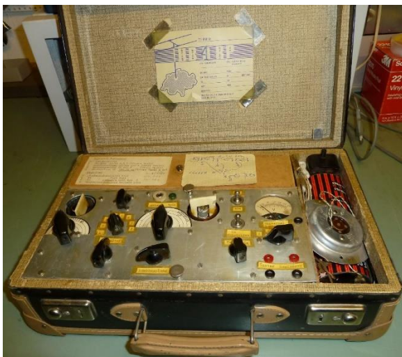
KW RX-TX (80m/40m/?) mit 6 Röhren von HB9RP, eingebaut in ein Köfferchen.
